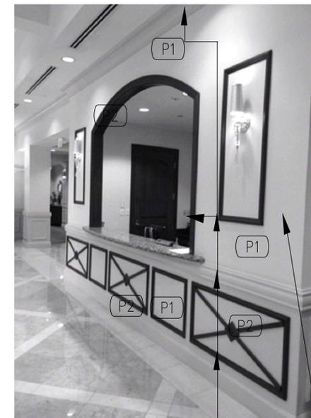
P2 ALL MOULDING DIRECTLY UNDER SOFFIT LINE
